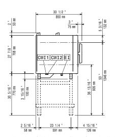
Raccordement eau froide Connexion électrique CWI2
